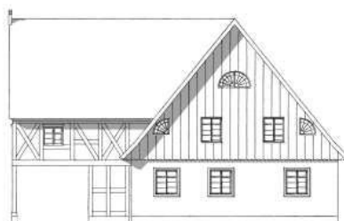
Ryc. 6.3.4. Dom podcieniowy typ III podcień prostopadły do kalenicy rys. M.Koperska-Kośmicka
