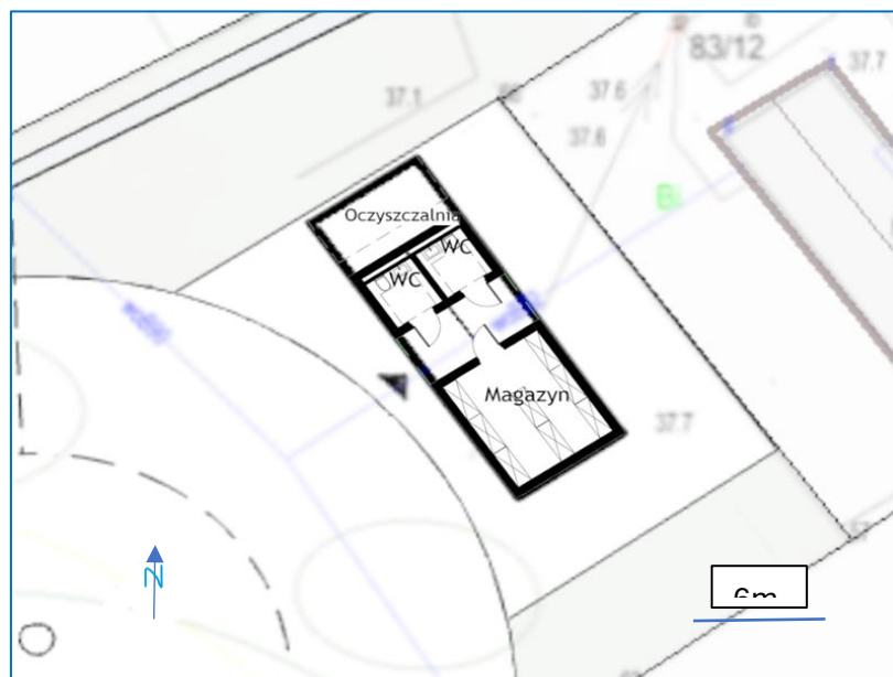
Rycina 8 Rzut budynku zaplecza (Opracowanie własne)
