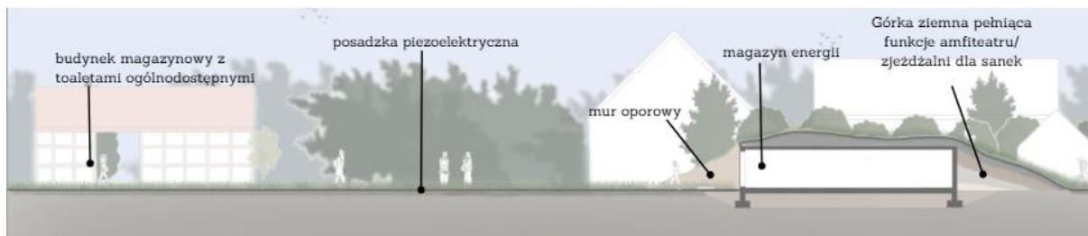
Rycina 11 Przekrój przez magazyn energii (Opracowanie własne)
